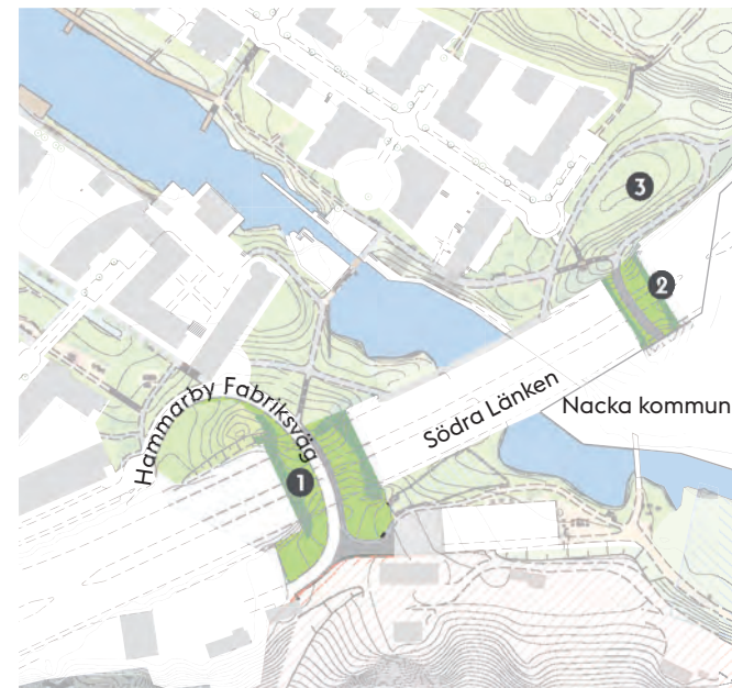
1. Ekodukt över till Hammarbybacken, 2. Ekodukt över till Sickla, 3. Gräsyta för bollspel och pulka. Skala 1:2000.
