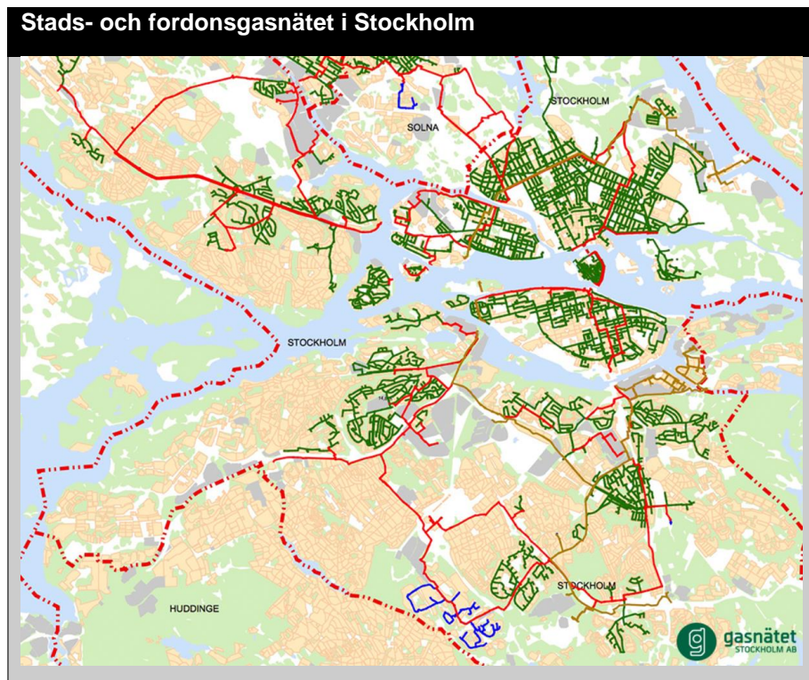
Figur 10; Stadsgasnätet (grönt visar lågtryck, blått mellantryck och rött högtryck), och Fordonsgasnätet (orange). Källa: www.gasnätetstockholm.se
